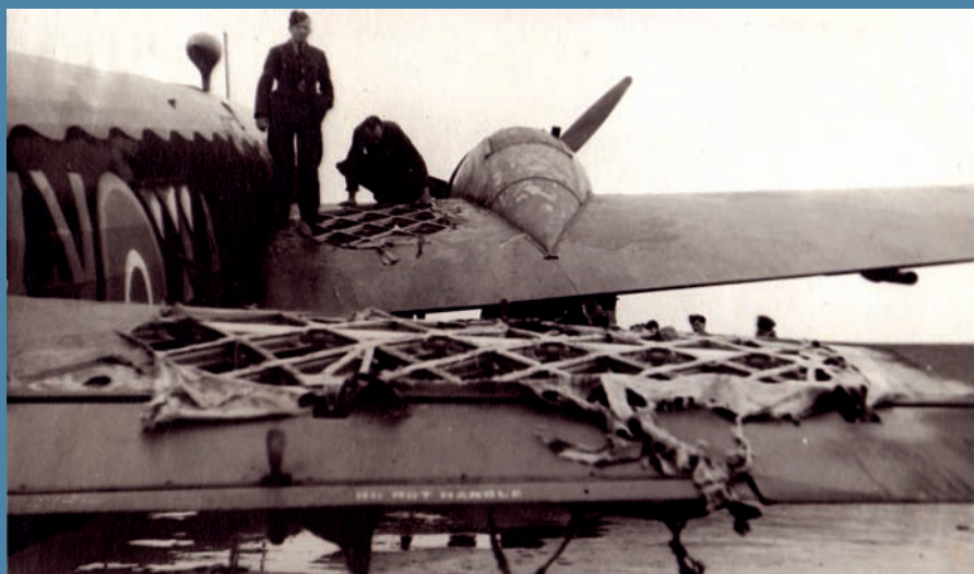
Bircham Newton, 26. 6. 1942. Památka na „tisícový“ noční nálet na Brémy. Nepřátelský flak zasáhl Wellington Mk.IC na řadě míst a zapálil mu pravý motor, od něhož chytla i část potahu. F/Lt Josefovi Stránskému, DFC, se však požár podařilo v piké uhasit a šťastně se vrátil
