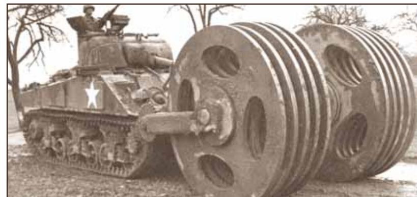
Tank Sherman s namontovaným válcovým odminovačem velkého průměru
