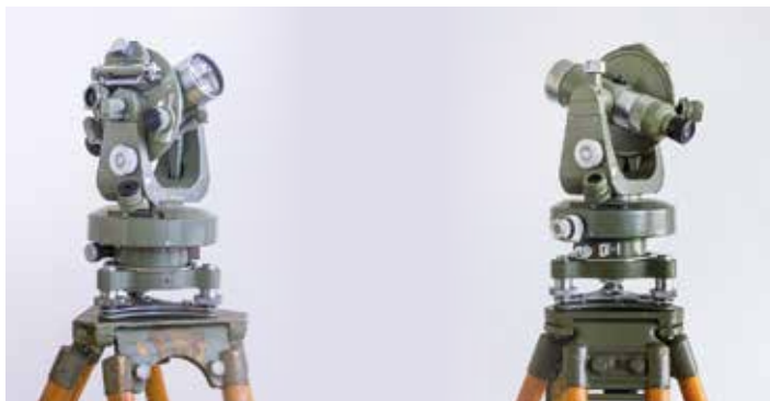
V 50. letech minulého století byly pro měřické práce využívány výrobky československé firmy Meopta – vlevo nivelační teodolit Meopta TE D4; vpravo teodolit Meopta Th-30.
