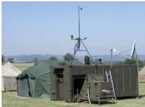
Přemístitelný prostředek hydrometeorologického zabezpečení OBLAK
