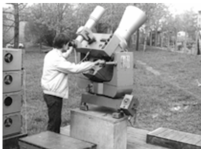
Měření s rádiovým dálkoměrem GET-B1 (vlevo) a fotokomora na fotografování umělých družic Země AFU 75 (vpravo)
