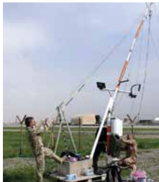
Rozvinutí automatické letecké meteorologické stanice AWS-310 v rámci operace NATO - ISAF v Afghánistánu na letišti v Kábulu
