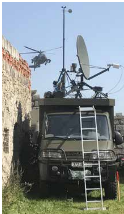
Zabezpečení letového provozu v polních podmínkách prostřednictvím mobilního prostředku hydrometeorologického zabezpečení BLESK
