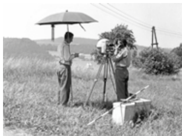
Měření s rádiovým dálkoměrem GET-B1 (vlevo) a fotokomora na fotografování umělých družic Země AFU 75 (vpravo)
