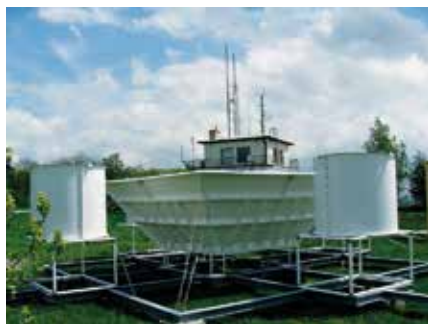
Zařízení pro měření směru a rychlosti výškového větru Wind Profiler na meteorologické stanici Znojmo-Kuchařovice
