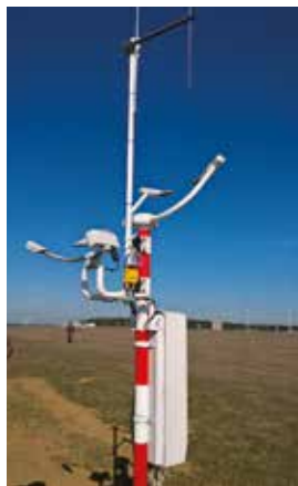
Zařízení k měření dráhové dohlednosti FS11-P
