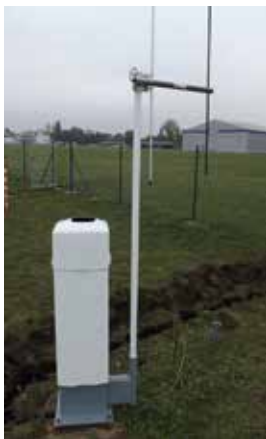
Zařízení k měření spodní základny oblačnosti Ceilometr CL-31
