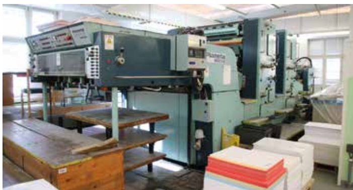
Tiskový stroj Planeta P26-Varimat polygrafického pracoviště Vojenského geografického a hydrometeorologického úřadu v Praze
