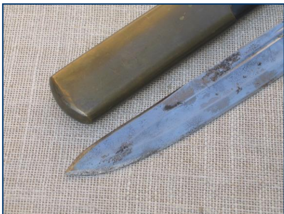
Detail hrotu čepele s nákončím pochvy. Korozní křusta narušila povrch především u hrotu a na fazetě ostří.
