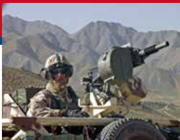
V bojovém nasazení se mimořádně osvědčil 30mm granátomet AGS-17 se schránkovým zásobníkem na 29 nábojů
