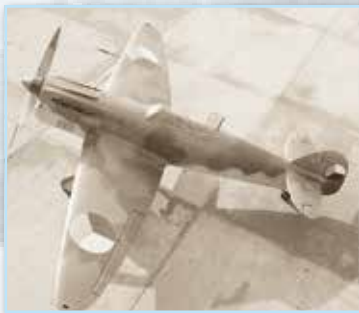
Prototypy strojů moderní konstrukce přišly pozdě. Dolnoplošná stíhačka Avia B-35, která již měla výkony na evropské úrovni, byla zalétána až za zářijové mobilizace. Její vývojový následovník, Avia B-135, vybavená již zatahovacím podvozkiem, sice dosahovala max. rychlosti 535 km/h, ale vyráběna byla až v průběhu okupace – malá série směřovala do Bulharska.
