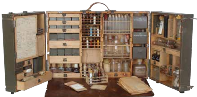
Objevují se nové prostředky pro chemický průzkum, jako byla například přenosná chemická laboratoř PCHL-54.
