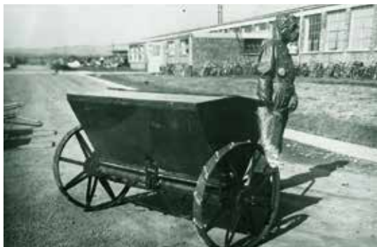
Pojízdný dvoukolový asanační vozík A-6, který byl zkonstruován u dělostřeleckého oddílu 401 v polovině 30. let a měl sloužit asanačním hlídkám.
